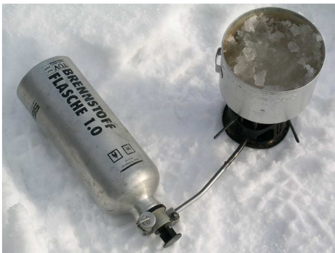
Slika 13.1: Za taljenje snega potrebujemo veliko energije. Slika prikazuje bencinski kuhalnik, ki je primeren predvsem za zahtevnejše zimske ture.
