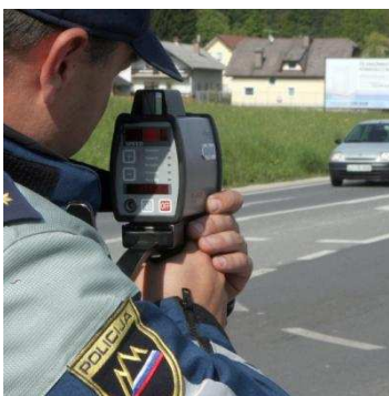
Slika 12.5: Dopplerjev pojav uporabljamo za merjenje hitrosti. V primeru na sliki je valovanje elektromagnetno.
