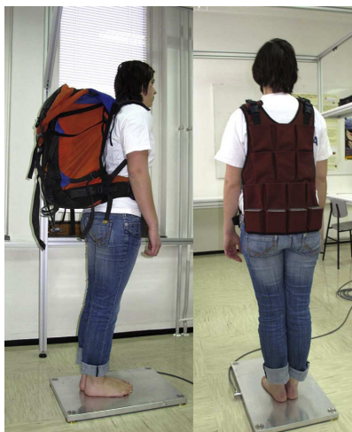
Slika 4.14: Laboratorijska meritev dveh različnih načinov nošnje bremena: v nahrbtniku in okoli trupa. (Biomehanski laboratorij Zdravstvene fakultete)
