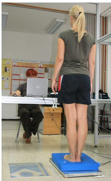
Slika 5.8: Stabilometrija: meritev gibanja projekcije težišča pri mirni pokončni stoji. (Biomehanski laboratorij Zdravstvene fakultete)
