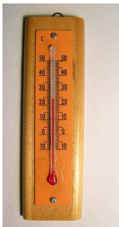
Slika 13.3: Sobni termometer uporablja za prikaz temperature raztezanje obarvane tekočine v stekleni cevki.
